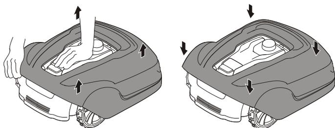
Halten Sie den Mäher mit einer Hand fest und heben Sie ihn an einer der Karosserieecken fest an und wiederholen Sie ihn für alle vier Ecken, bis sich die Karosserie vom Fahrgestell löst.
