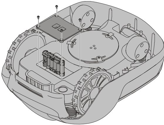
**WARNUNG!** Drücken Sie die **STOP-Taste** und ziehen Sie den **Sicherheitsschlüssel** ab, bevor Sie **Akkus** austauschen. Tragen Sie dabei **Schutzhandschuhe**.
