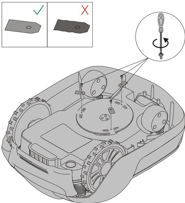
**UPOZORENJE!** Pritisnite gumb STOP i izvadite sigurnosni ključ prije zamjene noževa i nosite zaštitne rukavice.
