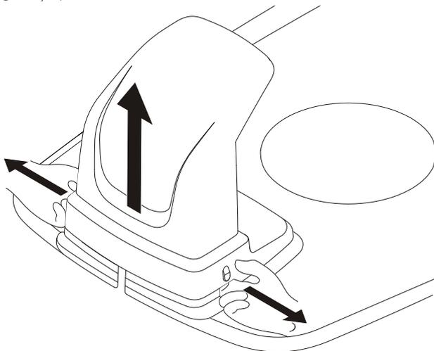
Îndepărtați capacul protector de pe stația de încărcare apăsând proeminențele de pe fiecare latură a bazei și ridicând capacul.
