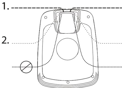
Suurimman osan latausasemasta on oltava työskentelyalueen sisäpuolella.
