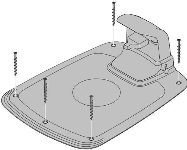
Befestigen Sie die Ladestation mit den fünf mitgelieferten Befestigungsschrauben mit einem 6 mm Innensechskant-Schlüssel am Boden.
