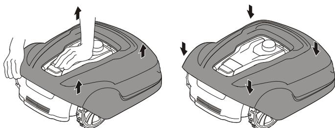
Segure o corta-relva com uma mão e levante firmemente em um dos cantos do corpo e repita para todos os quatro cantos, até que o corpo se solte do chassis.
