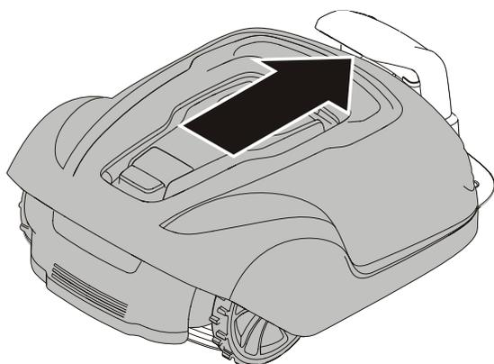
**AVVERTENZA!** Premere il tasto **STOP** e rimuovere la chiave di sicurezza prima di sostituire le lame e indossare guanti di protezione.
