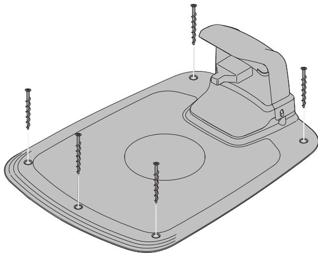
Gebruik een 6 mm inbussleutel om het laadstation aan de grond vast te maken met behulp van de vijf meegeleverde vastzetschroeven
