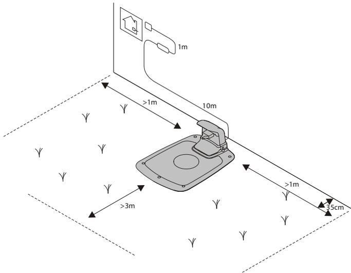
Stację ładowania należy ustawić w następujący sposób:
