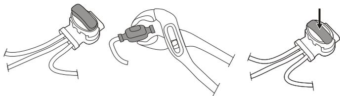
Inserire entrambe le estremità del cavo e gli estremità del filo di guida nella splice e guidare il filo. Controllare che i cavi siano ben inseriti nella Guida connettore splice e in modo che le estremità sono visibili attraverso l'guida splice e connettore.
