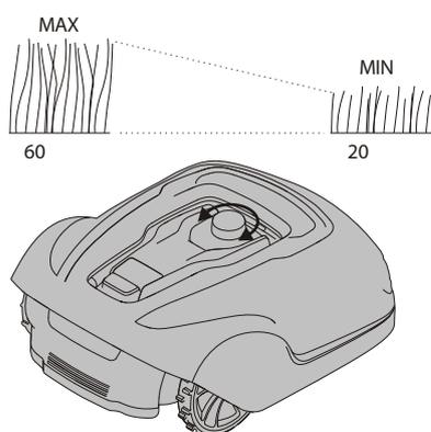
Aby nie dopuścić do przecięcia przewodu granicznego i przewodu prowadzącego, przez pierwszych kilka tygodni koszenia wysokość koszenia należy nastawić na 60 mm. Następnie ustawienie należy obniżyć o jedną pozycję tygodniowo, aż do uzyskania żądanej wysokości koszenia.
