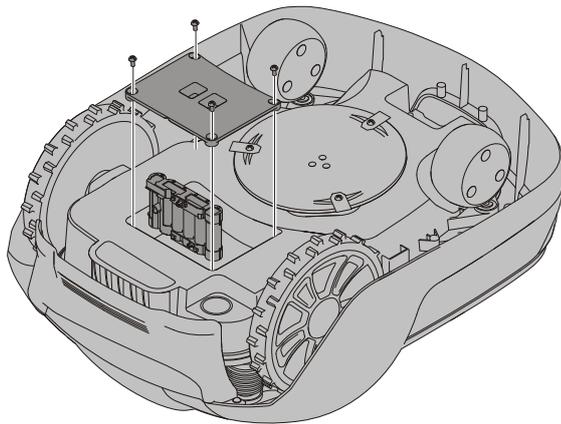
**ADVARSEL!** Tryk på stopknappen, og tag sikkerhedsnøglen ud før udskiftning af batterier. Husk beskyttelseshandsker.
