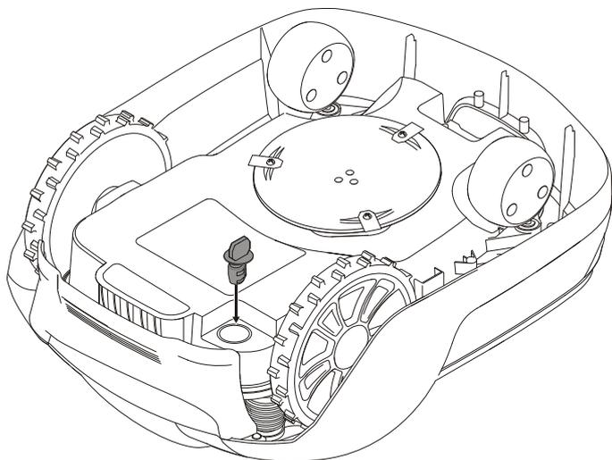
Włożyć kluczyk zabezpieczający do stacyjki w podwoziu kosiarki i przekręcić go w pozycję Włączone.
