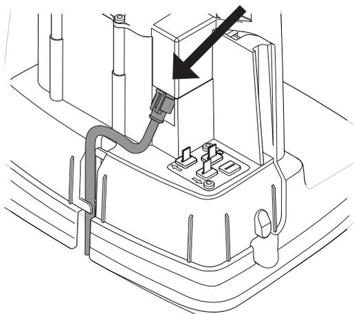
Csatlakoztassa a kisfeszültségű kábelt a töltőállomáshoz.
