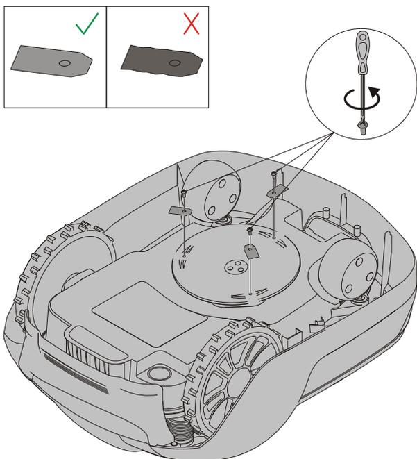
**OPOZORILO!** Preden zamenjate rezila, pritisnite gumb **STOP (USTAVI)** in odstranite varnostni ključ, pri tem pa nosite zaščitne rokavice.
