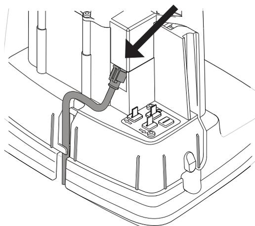
Zapojte nízkonapěťový kabel do nabíjecí stanice.
