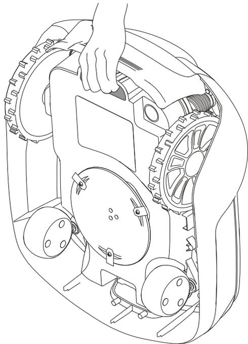
Pred dviganjem kosilnice pritisnite gumb **STOP** (USTAVI) in odstranite varnostni ključ.
