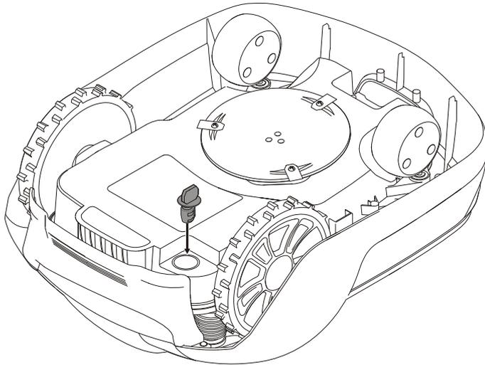
Introduceți cheia de siguranță sub robotul de tuns și rotiți în poziția Enable (Activare).
