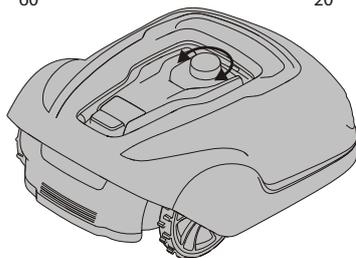
Durante las primeras semanas de corte, ajuste la altura de corte a 60 mm para evitar cortar el cable delimitador y el cable de guía. Posteriormente, baje el ajuste un paso cada semana hasta que se alcance la altura de corte deseada.
