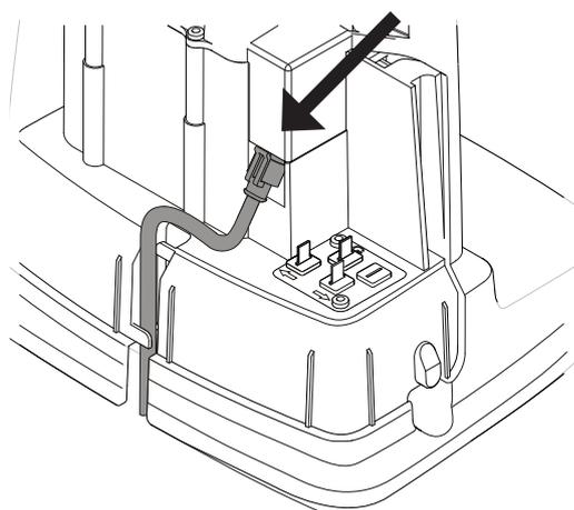
Podłączyć kabel niskonapięciowy do stacji ładowania.
