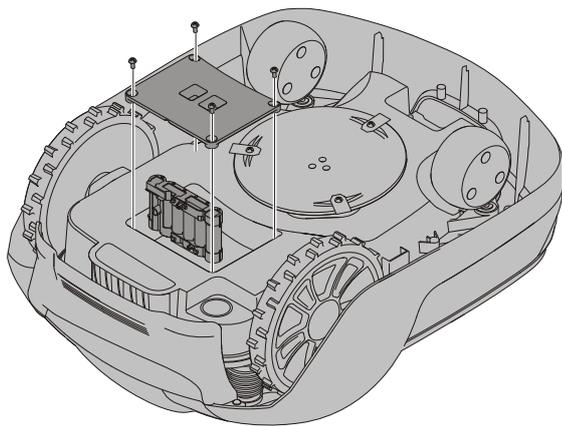
**AVERTISMENT!** Apăsăți butonul **STOP** și îndepărtați cheia de siguranță înainte de a înlocui bateriile și purtați mănuși de protecție.
