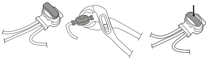
Illessze a határolóhuzal mindkét végét és a vezetõhuzal végét a huzaltoldó vezetõhuzal összekötõbe. Ellenõrizze, hogy a huzalok teljesen a huzaltoldó vezetõhuzal összekötõben vannak-e úgy, hogy a végek láthatóak a huzaltoldó összekötõn keresztül.
